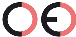
Falsche CE-Kennzeichnung (zu großer Zwischenraum)
